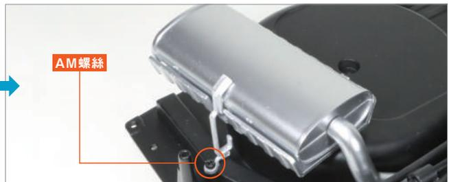
將主消音器支架 29-G 的突起部分和螺絲孔與 29-E 的凹槽和 21-A 的背面螺絲孔對齊，然後使用 AM 螺絲 固定。
