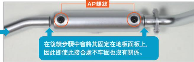
將副消音器 (2) 29-B 背面的螺絲孔與 29-A 背面的螺絲孔對齊，並使用 AP 螺絲 固定兩個位置。
