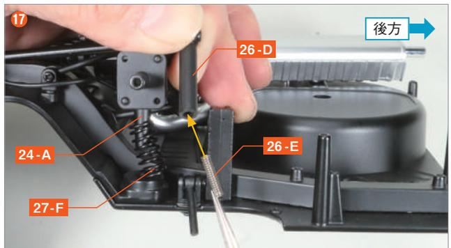
備妥第26期提供的2個避震器彈簧 26-E 和第27號提供的2個後螺旋彈簧 27-F。將後軸抬起，將其中一個 27-F 穿過後軸殼上側 24-A 的突起部分，將一個 26-E 插入後避震器下部 26-D 的洞孔中。
