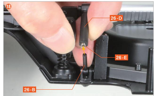
將 26-E 放入 26-D 中，將後避震器上部 26-B 的前端插入 26-D 的洞孔中。
