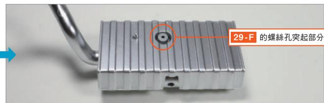
將主消音器隔熱板 29-J 的突起部分，對齊 29-F 的兩個洞孔並插入。
