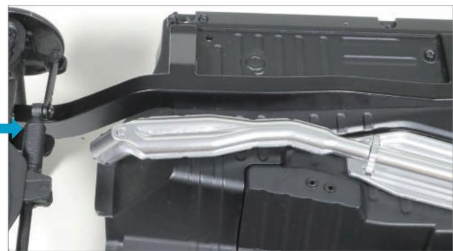
將第28期提供的排氣管前段 (2) 28-C 背面的3處突起部分，對準 28-A 的3個洞孔嵌入。
