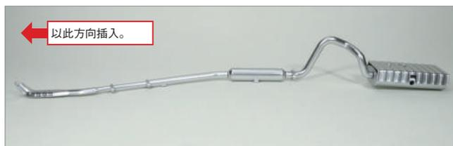
將排氣管安裝到地板面板上。抬起後軸，將在 step 1 中組裝好的排氣管，從後軸的下方穿過插入。
