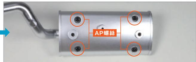
將 29-E 的螺絲孔突起部分與主消音器 (2) 29-F 背面的螺絲孔突起部分對齊嵌入，並使用 AP 螺絲 固定四個位置。
