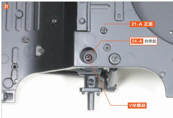
在壓住 26-B 以防止其從 26-D 鬆脫的同時，將地板面板翻轉至正面，將 24-A 的突起部分放入 21-A 的洞孔中。讓 24-A 的前端從 21-A 的洞孔中稍微突出，並用 VM 螺絲 確實固定。與步驟 18 相同，事先確保後軸可以上下移動。
