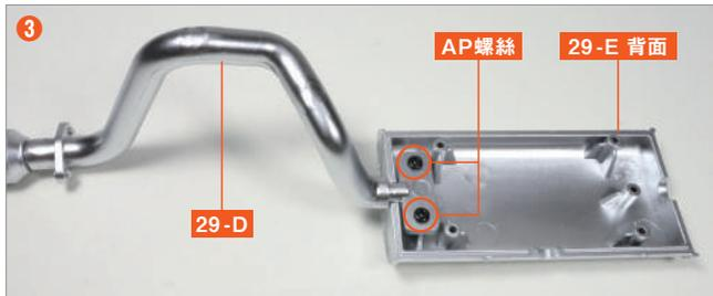
將 29-D 的螺絲孔與主消音器 (1) 29-E 背面的凹槽和兩個螺絲孔突起部分對齊，並使用 AP 螺絲 固定兩個位置。
