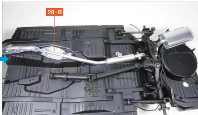
將前端放置在前置隔熱板 28-B 上。
