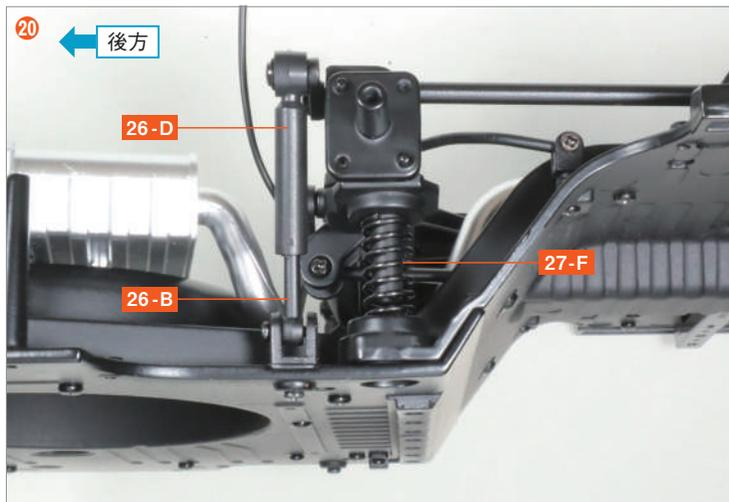
以相同的方式進行另一側，將另一個 27-F 穿過 24-A 的突起部分，將另一個 26-E 插入 26-D 的洞孔中。然後，將 26-E 放入 26-D 中，將後避震器上部 26-B 的前端插入 26-D 的洞孔中。
