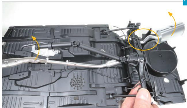
一邊按箭頭方向旋轉，一邊將 ○ 圈起的部分插入後軸的下方。
