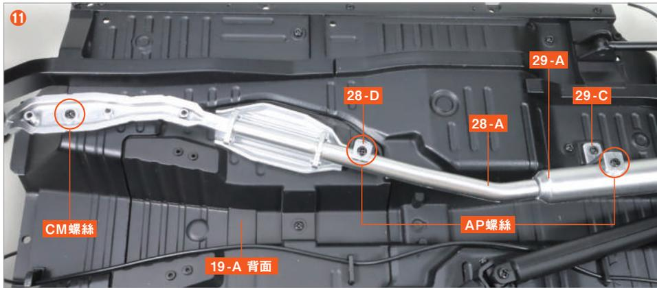
將 28-A 前方的螺絲孔與 19-A 背面的螺絲孔對齊，使用 CM 螺絲 固定。接著，將 28-D 和 28-A、29-C 和 29-A 的螺絲孔對齊，用 AP 螺絲 固定。
