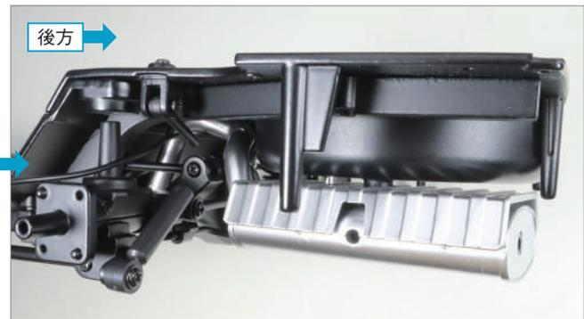
將 29-J 的突起部分和 29-F 的螺絲孔的突起部分，分別對準後地板面板 21-A 的兩個洞孔。
