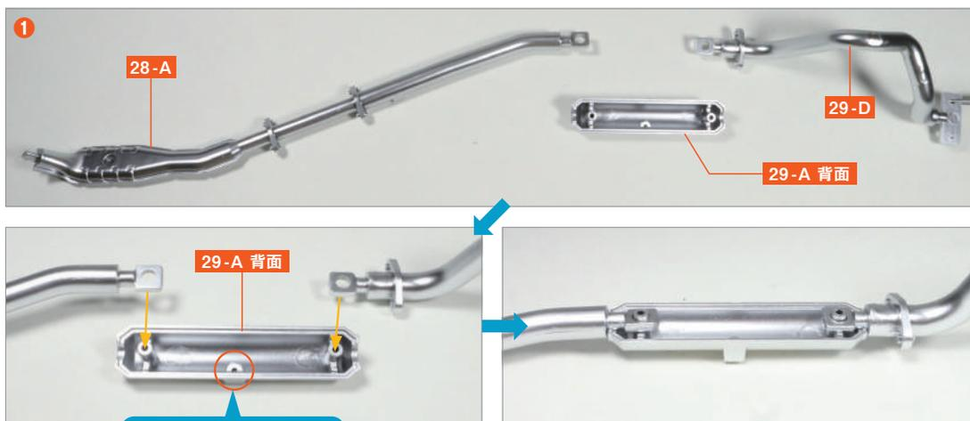
將第28期提供的排氣管前段(1) 28-A 與排氣管後段 29-D 前方洞口分別對齊並組裝到副消音器(1) 29-A 背面的兩個螺絲孔突起部分。
